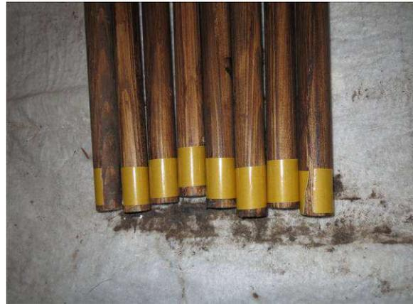
Nun das kleine Stück Rohrisolation anbringen. Es sollte überlappend über das Speerende hinaus montiert werden so dass wieder ein Puffer entsteht.
