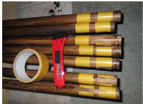
Klebebandfolie entfernen und 15cm langes Stück Rohrisolation über das Rundholz stülpen. Das Klebeband verhindert ein Umher rutschen der Isolationsröhre.
